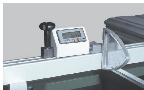
O Doraz s digitálním odečítáním • Digital indication • Digitalanzeige Indicator digital • Indicateur digital • Электронный индикатор
