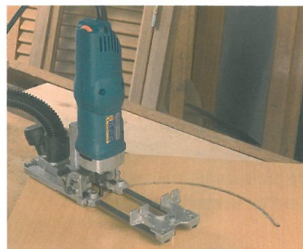
Réalisation de rainure circulaire obtenu avec le compas livré d'origine.
