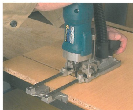
Rainurage sur chant pour pose de chant queue de sapin, de seuil de porte, assemblage par languette, etc...
