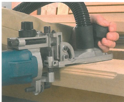
Réalisation de moulures en jouant sur les différents degrés.
