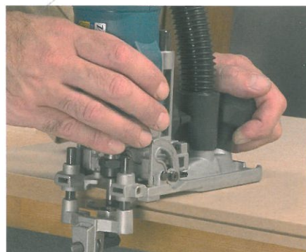
Rainurage sur chant pour pose de chant queue de sapin, de seuil de porte, assemblage par languette, etc...
