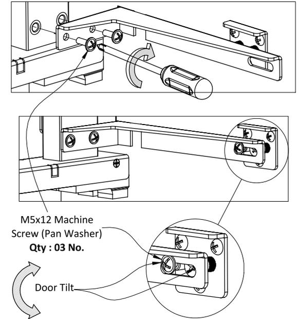
**Step No: 06** \* Door Bracket Parts Fixing
