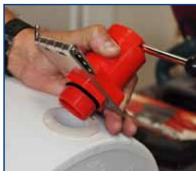
Visser la vanne sur l'insert fileté du seau, toujours dans le sens horaire pour ne pas risquer de dévisser l'insert fileté
