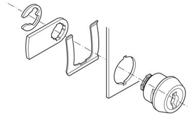
**Fixation par écrou avec écrou hexagonal**
