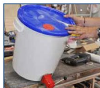
La charnière de la vanne permet de basculer le seau pour le vider entièrement
