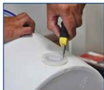
Basculer le seau sur le côté et inciser la membrane à l'aide d'un cutter.
